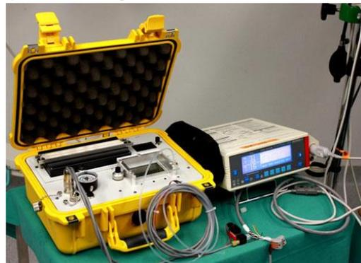
Dieses System wendet die Needle-Trap-Mikroextraktion (NTME) an und ermöglicht eine automatisierte Probenahme der Alveolarluft, wodurch unerwünschte Messungen aus der Totraumluft ausgeschlossen sind.
